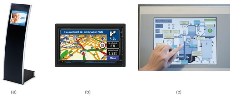
**Abbildung 2.11:** Beispiele für den Einsatz von Touchscreens. (a) Kiosk-System, (b) Navigationsgerät und (c) Bedienpanel. (Quellen: <http://www.cmb-systeme.de/products/Digital-Signage/Indoor-Kiosksysteme/Kiosksystem-Infoterminal-ISIS.html>, [http://www.kenwood.de/products/car/navi/all\\_in\\_one/DNX8220BT/](http://www.kenwood.de/products/car/navi/all_in_one/DNX8220BT/), <http://www.drwa-media.de/aco-passavant/pressebild/2012-09-24/aco-haustechnik-nassmuell-touchpanel> )
